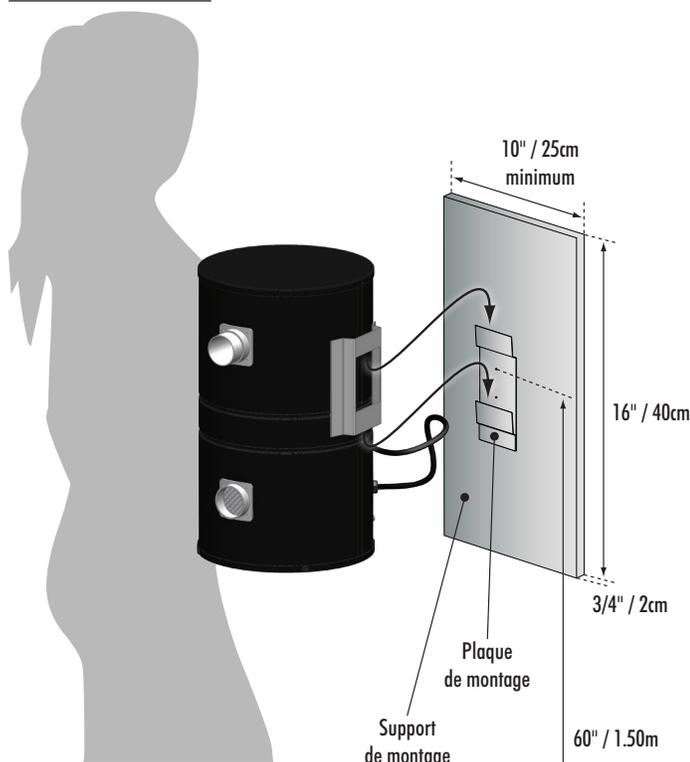
Fig.2 Installation de l'unité motrice au mur.
