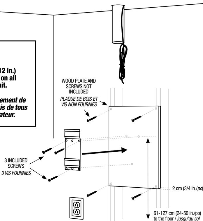
② VACUUM UNIT INSTALLATION | INSTALLATION DE L'ASPIRATEUR
