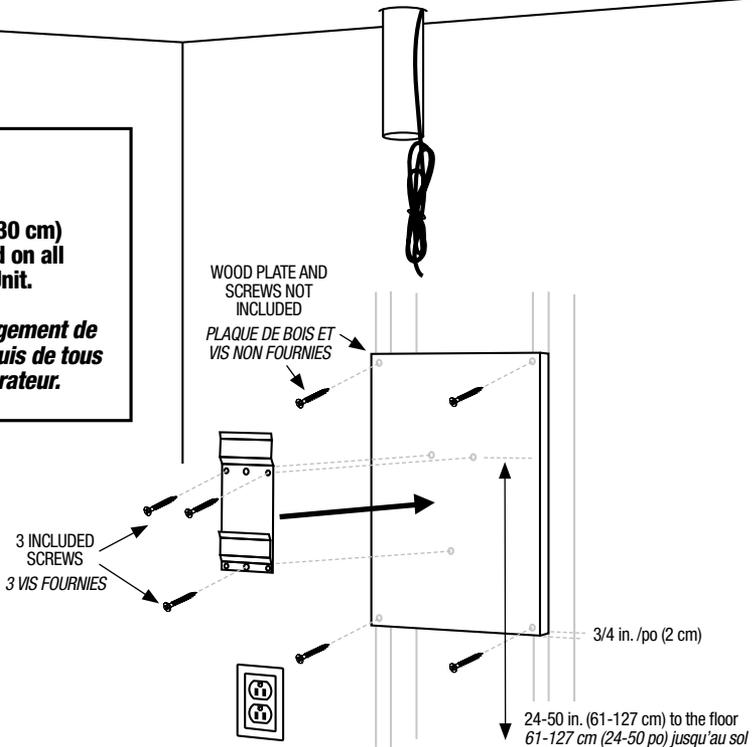
② VACUUM UNIT INSTALLATION | INSTALLATION DE L'ASPIRATEUR
